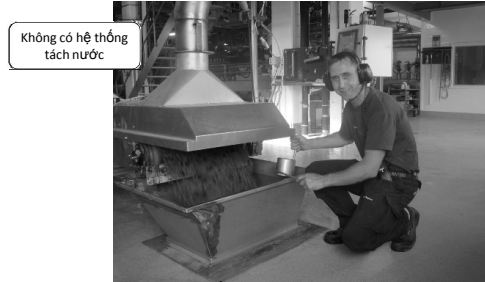
Hình ảnh thực tế: Băng tải từ máy ép đùn đến máy sấy – công suất ép đùn 24 t/h
